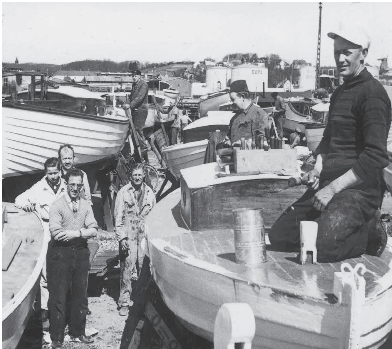
Sejlbåde males og klargøres på land omkring 1950. Mange arbejdstimer kunne spares ved at investere i en glasfiberbåd. Fotograf: Ukendt.
