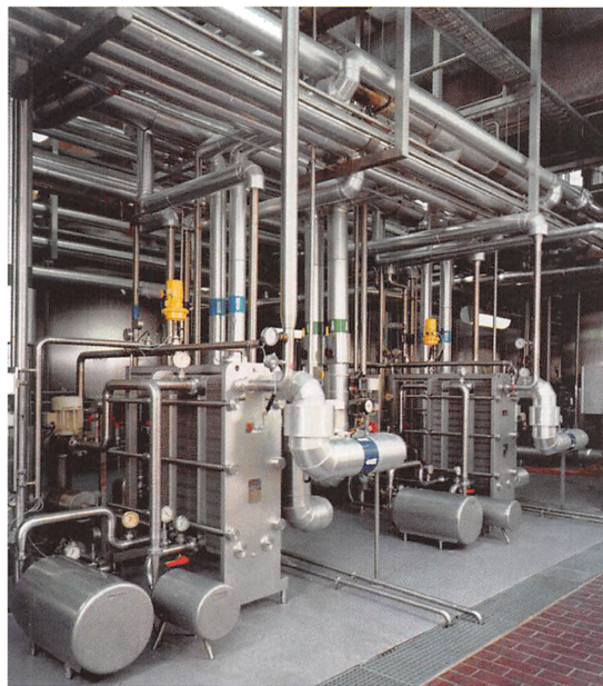
To højtrykspasteuriseringslinier, hver for 18000 liter øl pr. time.
