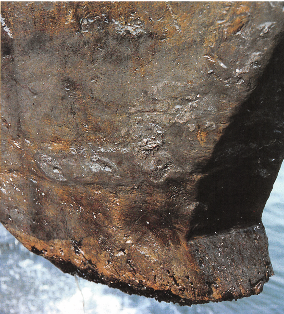
Aftryk af L-formet rorbeslag på agterste stævknæ. Foto: Line Dokkedal, 2001.
